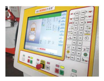
基于PC-PLC平台的图形化设计触屏操作系统,运算处理功能 更加精准,功能更强大。
